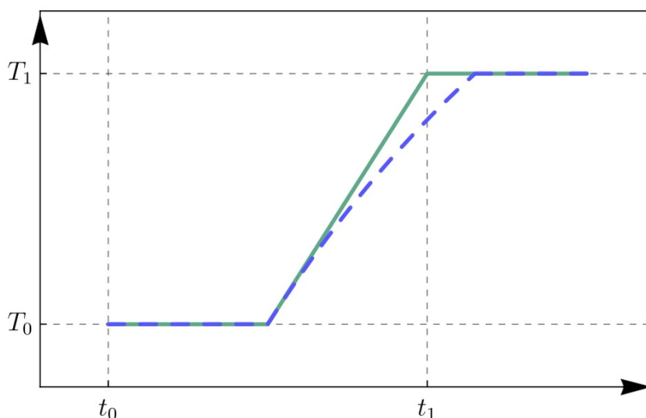
Рис. 2: Зависимость температуры от времени при учёте теплообмена со средой (кривая синего цвета соответствует учёту теплообмена).
