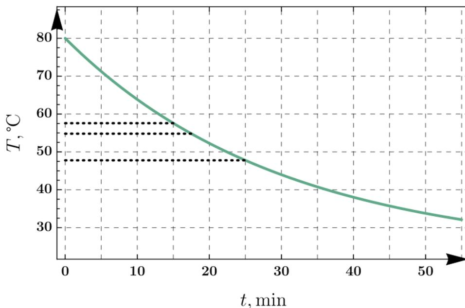
Рис. 3: Зависимость температуры воды в чайнике от времени при охлаждении из-за теплообмена со средой. Время измеряется в минутах. Дополнительные горизонтальные отрезки соответствуют 15, 17.5 и 25 мин.
